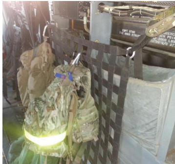
US Air Force Side-wall Cargo Stowage Net for V22 Armée de l'air américaine Filet d'arrimage latéral pour V22
