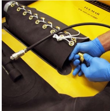
Installation de la bouteille d'air comprimé
