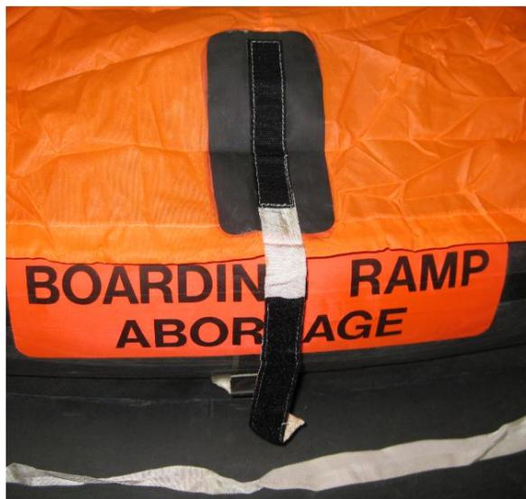
Enfiler le bout du ruban Velcro au travers de l'anneau situé sur la chambre et retourner le ruban sur lui-même pour sécuriser.
