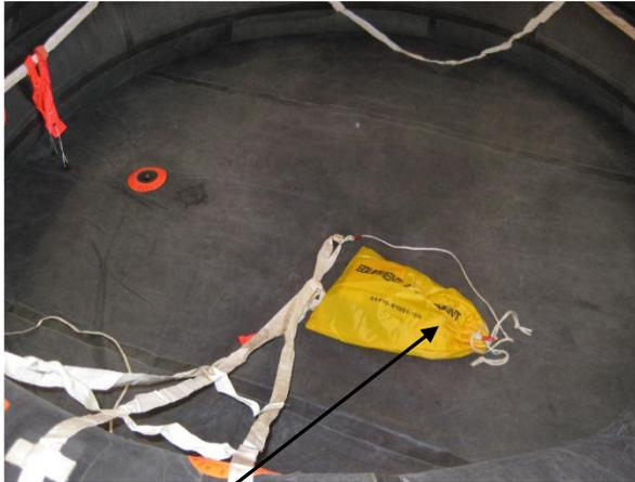
Equipment Bag (located at the center of the raft floor and is secured to the ladder assembly) / Sac d'équipement (situé au centre du fond du radeau, attaché à l'échelle)
