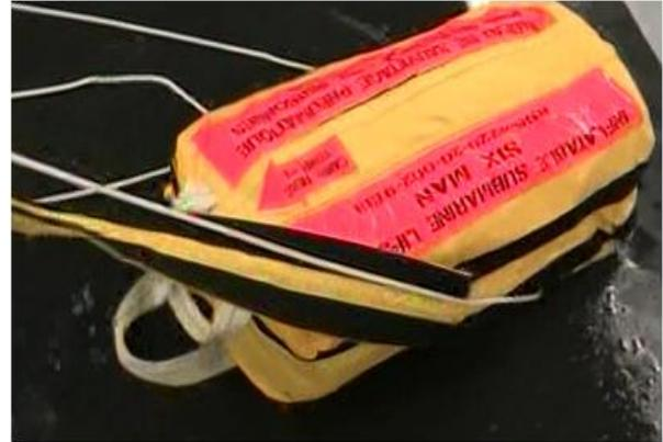
4. En tirant sur la ligne d'opération, la soupape du cylindre contenant le CO<sub>2</sub> est activée remplissant ainsi les chambres de flottaison de ce gaz.
