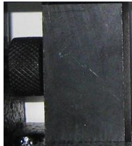
Outil sertisseur, extrémité de filière avec vis p/n 5681-106
